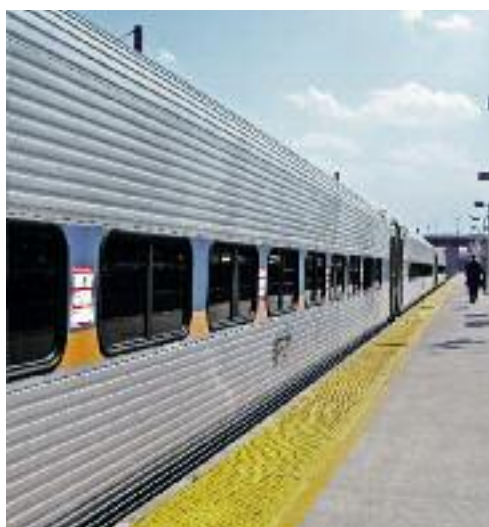
Fig. 25: Vagnskorgar för person- tåg med ytterpaneler av austenitiskt rostfritt stål har använts i många de- lar av världen utan pro- blem med galvanisk korrosion.
