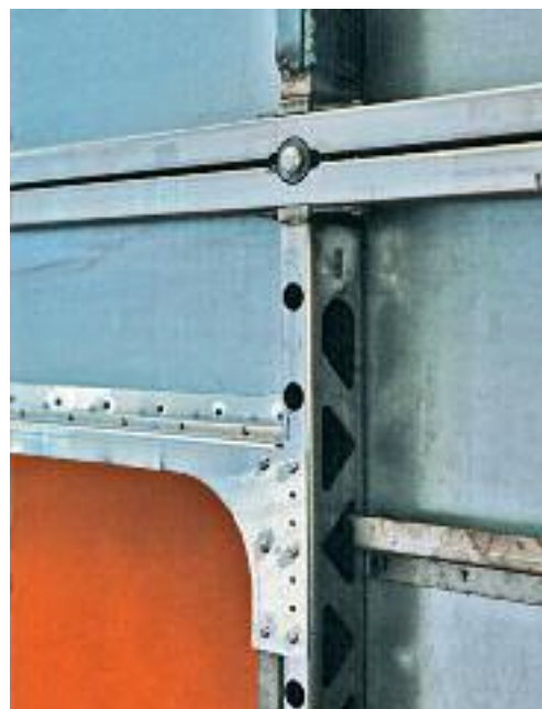
Fig. 23: I denna sidovägg på ett pendeltåg är stommen och den yttre panelen av olika typer av rostfritt stål. Eftersom dessa har identiska potentialer kan ingen galvanisk korro- sion uppstå.
