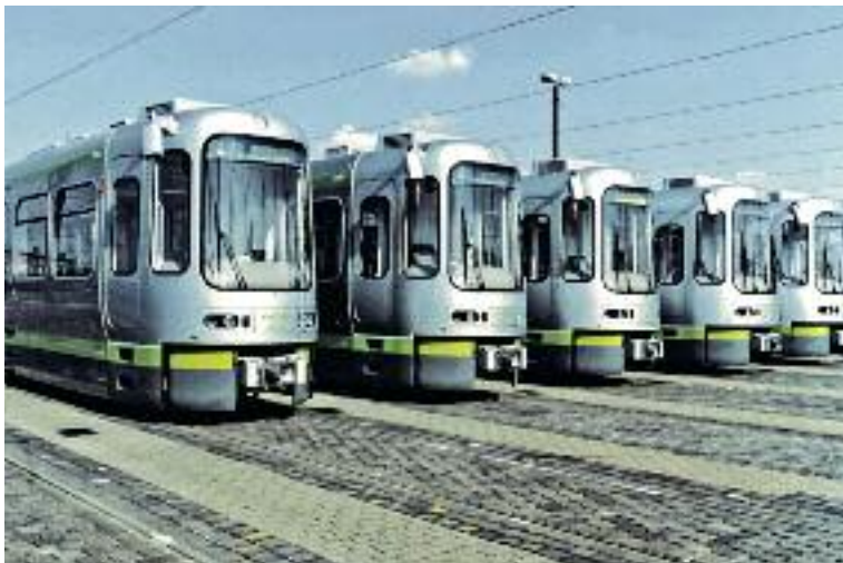
Fig. 22: Enkel isoleringsteknik gör att spårvagnens ka- ross av ferritiskt rostfritt stål kan kombineras med chassit av kolstål.
